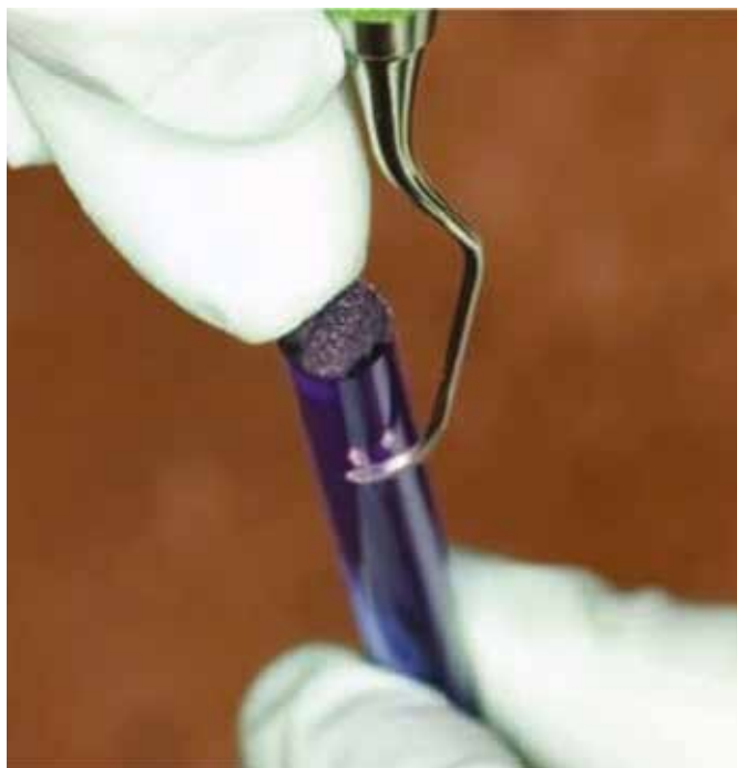
Joonis 3. Küreti teravuse kontrollimine akrüülist testpulgal.
